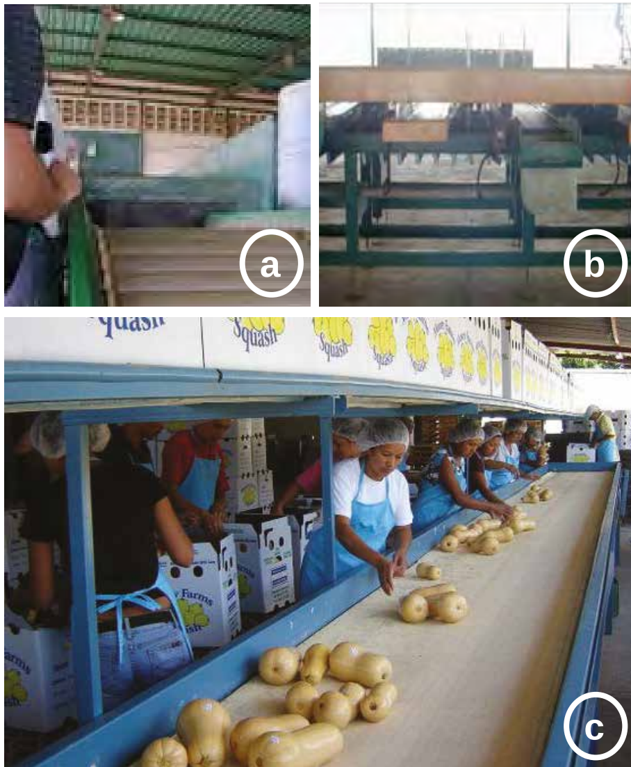
Figura 35. Equipos para la clasificación de frutos de melón. Banda transportadora de rodillos (a), clasificadora (b) y clasificación manual (c).
